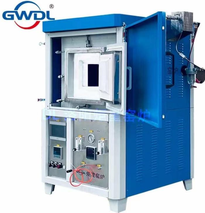
GWL-ZQLB 系列 1700 度真空气氛箱式电炉如图所示，集温度控制系统、真空炉膛、真空泵、气路、压力保护、气体流量控制、正负压显示、水循环水泵为一体，水循环箱与炉体为粉体。炉衬使用进口真空成型高纯氧化铝聚轻材料制作而成。
